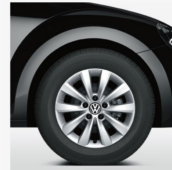
La llanta de aleación ligera "Mikca" de 16 pulgadas con neumáticos 215/ 60 R16 es otro de los toques de distinción del Beetle.
